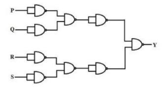
$$\overline{P} + \overline{Q} + \overline{R} + \overline{S}$$
